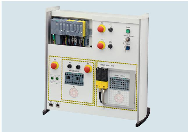
Der Trainingskoffer wird eingesetzt, um Programmieren, Bedienen und Inbetriebnahme von fehlersicheren Steuerungen SIMATIC S7-1500 innerhalb von TIA Portal praxisnah zu üben.
