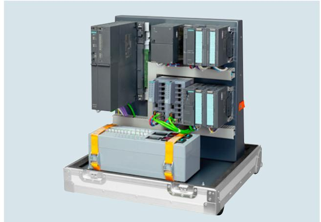
Die DCS Digital Base Unit neo wird eingesetzt, um die Projektierung eines Prozessleitsystems SIMATIC PCS neo anhand einer realen Steuerung CPU 410-5H praktisch zu schulen.
