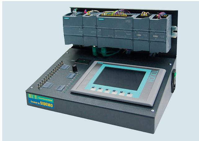
Der Trainingskoffer wird eingesetzt, um Programmieren, Bedienen und Inbetriebnehmen von speicherprogrammierbaren Steuerungen SIMATIC S7-1200 praxisnah zu üben.
